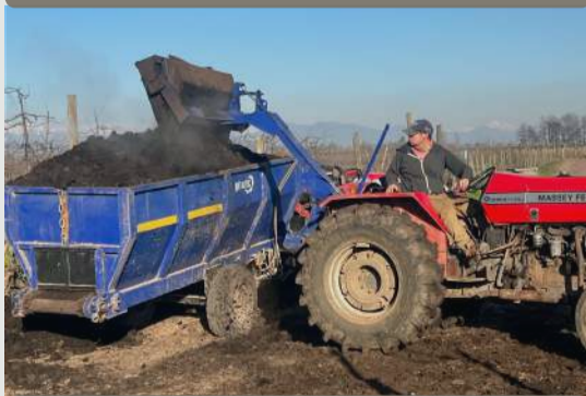
Buena opción: mecanización auto operada de aplicación de enmiendas
